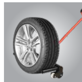
za podešavanje kotača na osovinu i transport
