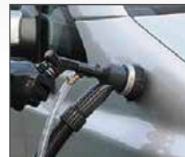
▶ Abrazivni materijal se odmah nakon udara na površinu usisava i reciklira.
